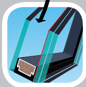
bezpieczna L3 - pakiet szibowy z zewnętrzną szybą hartowaną i powłoką łatwozmywalną Activ oraz wewnętrzną ze szkła laminowanego. Wnętrze wypełnione gazem szlachetnym. Ciepła ramka TGI
